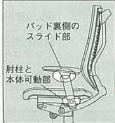
パッド裏側のスライド部 肘柱と本体可動部
